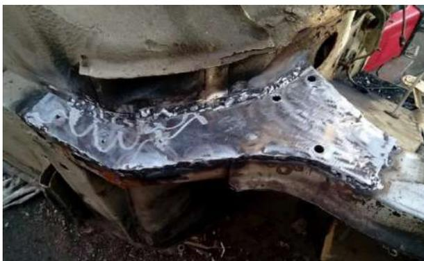
**Рис. Применение самодельного элемента и нарушение технологии сварочных работ при ремонте кузова** [<https://dr1ver.ru/17194-chto-takoe-lonzheron.html>]
