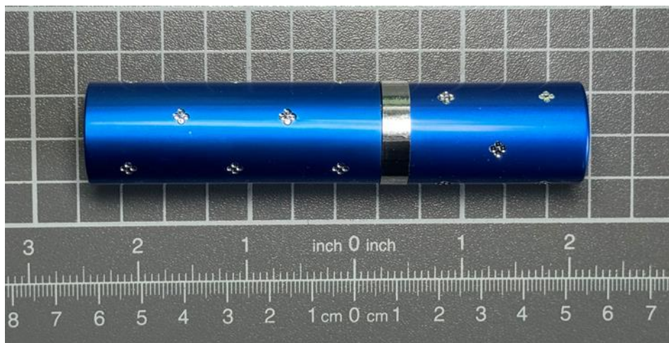
Рис. 1. Электрошоковое устройство 2 класса — «Оса-1112» в виде помады (напряжение разряда 10 тыс. Вольт)
