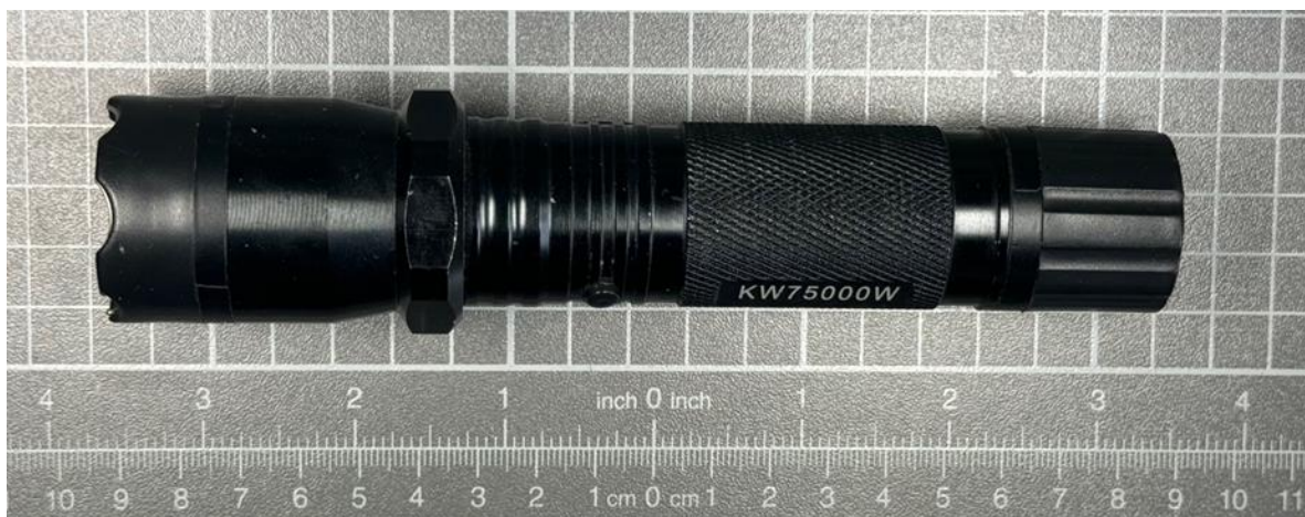
Рис. 2. Электрошоковое устройство 2 класса, в виде стационарного искусственного источника освещения (фонаря) — (напряжение разряда 1000 кВ)
